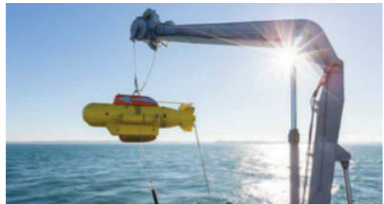
Poisson autopulsé pour guerre des mines
